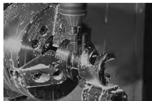
ATC型複合加工機「MX-100」での 膝関節インプラントの加工
