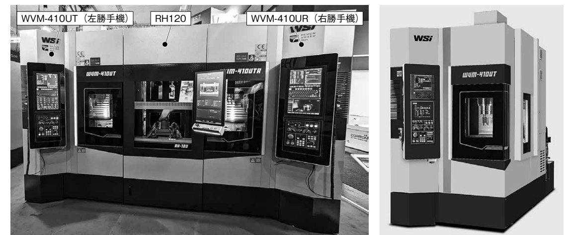
(a) WVM-410UT/URと両者をURを連結する自動化システム (RH120)
