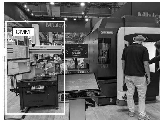
図2.16 工作機械とCMMの連携による閉ループ加工システム（ミットヨ）
