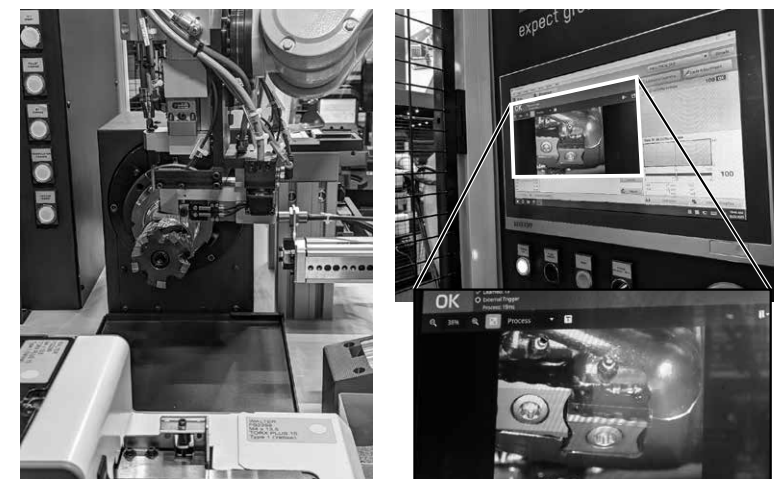
(a) チップ固定中の様子 (b) チップ摩耗状態の観察と判定 図2.2 インサートチップの自動交換 (ZOLLER)
