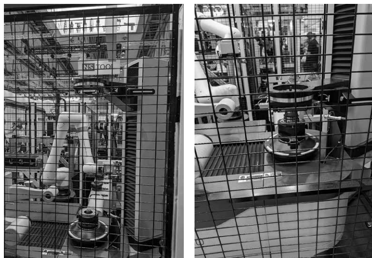
(a) システム全景 (b) 工具を固定する様子 図2.1 コレットチャックの工具自動交換 (ZOLLER)
