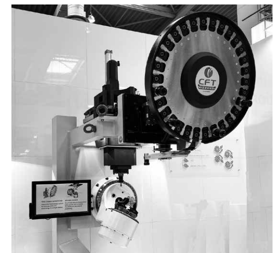
(b) 各ステーションに装備されたATCマガジン 図6.2 ATCと5軸加工機能搭載 ロータリトランスファセンタ (BTB)
