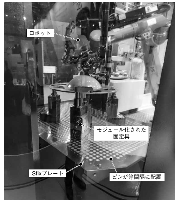
(c) Sfix-cellの組立てスペースの様子
