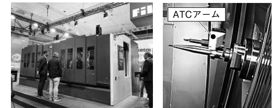
(a) SYNCROMILL D22-80 X2000の外観 (c) 水平直進運動するATCアーム
