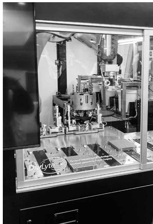
(b) スカラロボットによる工作物のホルダへの取付作業風景
