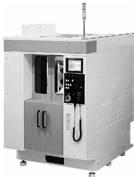
5軸CNC制御門型バリ取り加工機「バリスタ」
