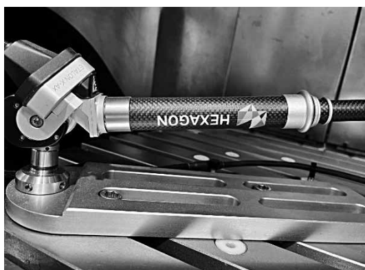
図16 運動精度計測の様子
