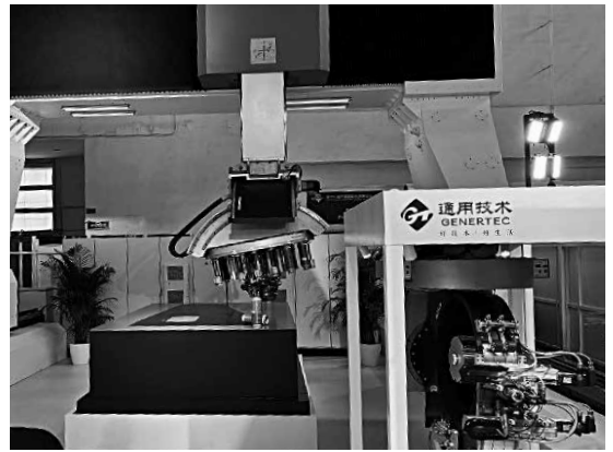
図4 ユニークな傾斜軸を搭載した門型機（左）と大型門型機（右）
