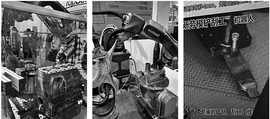
図14 加工ロボットの展示；ATIのやすりがけロボットアプリケーション（左）、 广州数控の溶接ロボット（中央）、广州数控のきさげロボット（右）
