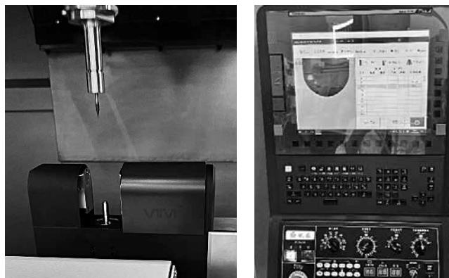
図15 刃先位置検出装置（威研科技）
