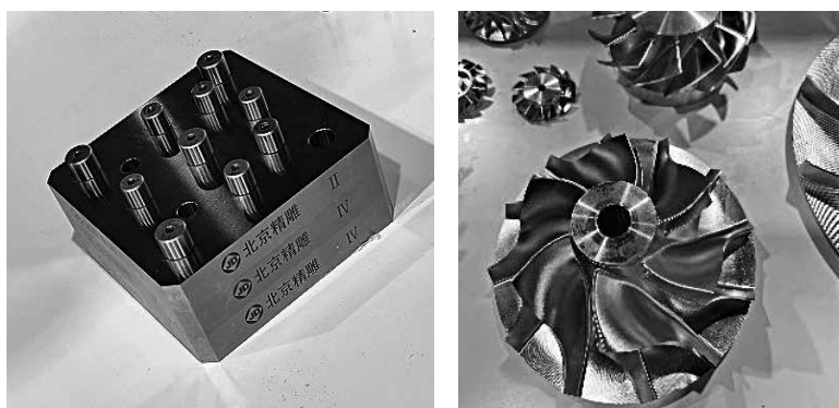
図7 加工事例；高精度加工（左）、5軸加工（右）
