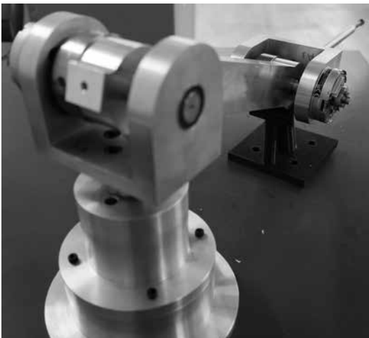
図4 自作したロボットアーム型3次元測定器
