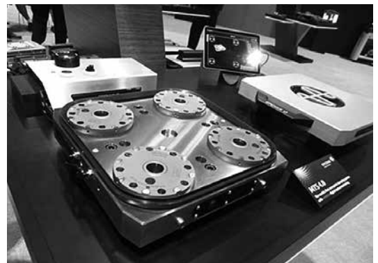
図6.4 EROWA社のワイヤレスセンサ付きMTS (Modular Tooling System)
