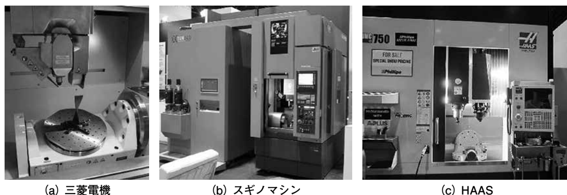
図3.2 5軸MCベースの金属積層造形加工機
