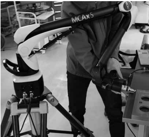
図3 ロボットアーム型3次元測定器の精度向上のための研究
