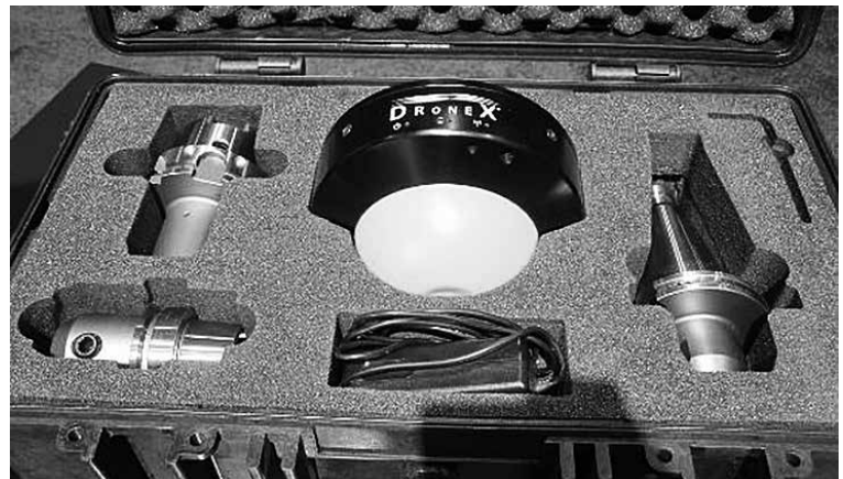
図4.2 イタリアParpasグループによる空間精度測定装置
