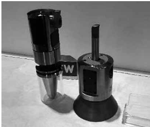
図6.1 Big Kaiser社の寸法自動調整機能付き中グリ 工具ホルダ EWA Automatic Fine Boring System
