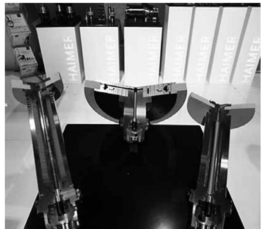
図6.3 HAIMER社のスピンドルスルー研削液供給機能を持つ砥石ホルダのカットモデル
