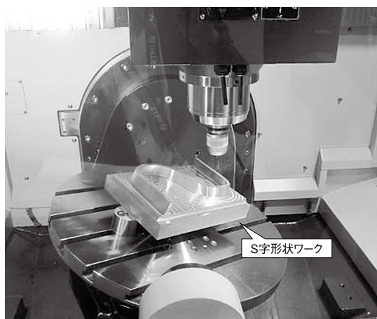
(a) FFG（友嘉実業集団）による同時5軸制御加工
