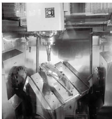
(b) AXILE（達佛羅股份）による同時5軸制御加工
