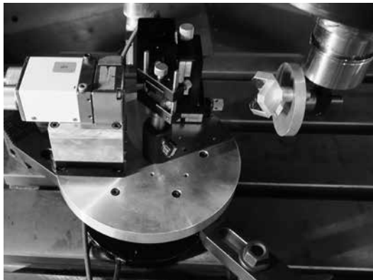
図6 2次元レーザトラッカの試作
