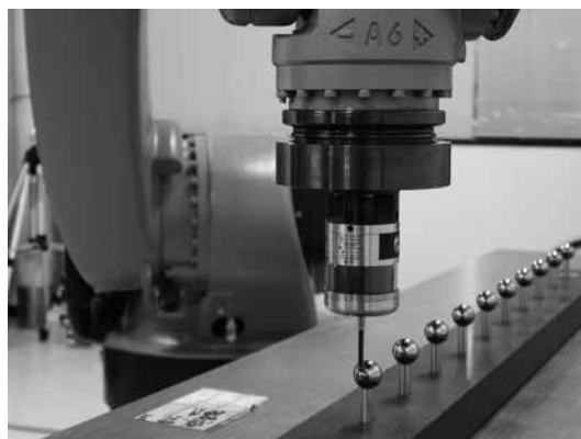
図1 ロボットを使ったタッチプローブ測定
