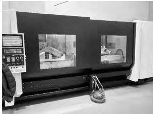
1台で5軸機能2台分を集約したユニークな加工機（SW社）
