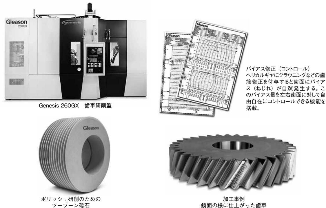
図 2.3 ミラー級の歯面を実現する歯車研削盤 (Gleason)
