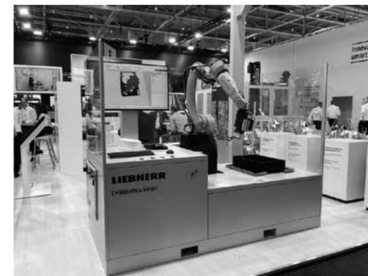
図 3.7 ロボットによるピックアンドプレイスシステム (LIEBHERR)
