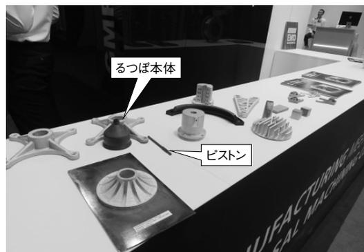
図 6.3 造形部品例とノズル構成部品 (“るつぼ” 及び “ピストン”) (GROB)
