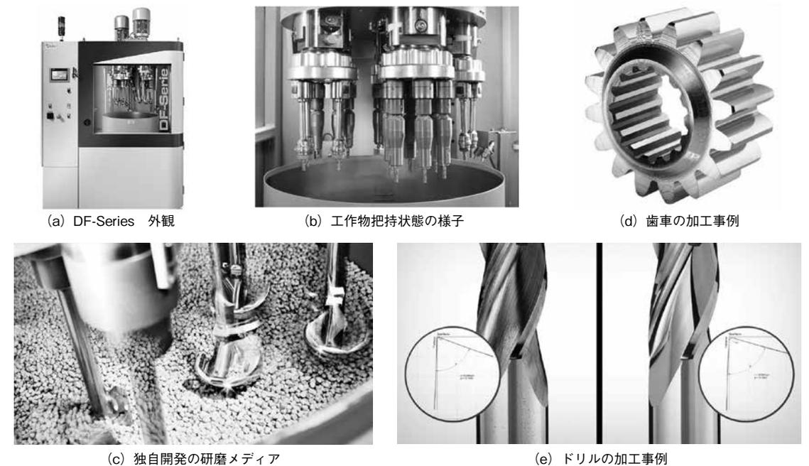
図 2.4 DRAG Finishing Machine (OTEC)
