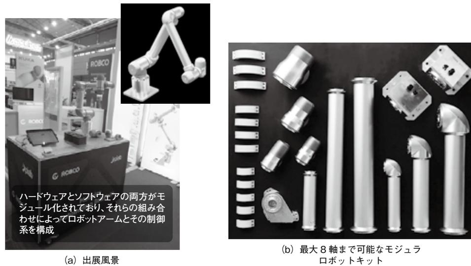
図 3.9 モジュール化されたロボットシステム (ROBCO)
