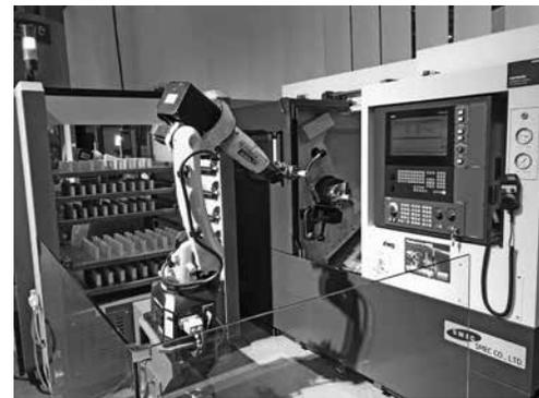
②複数台の機械間を搬送装置が往来することで、ツールの自動交換をコンパクトに行うシステム。この会社では、東南アジア向けの輸出にも力を入れており、人件費が高騰してきているインドやベトナム、中国向けに自動化提案を行っている模様。
